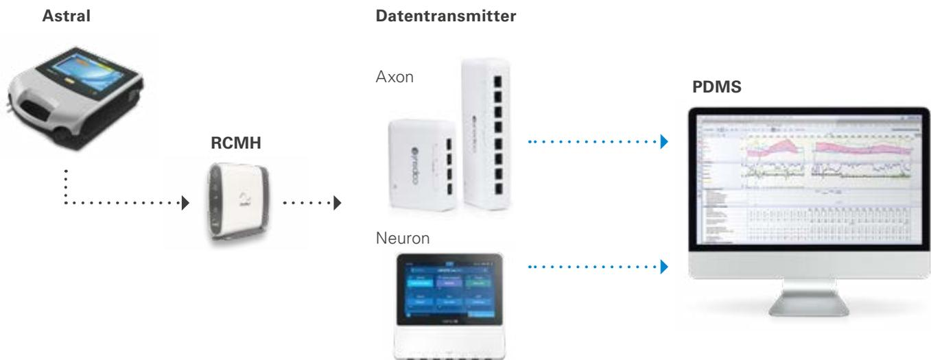
Ganz einfach das Beatmungsgerät Astral über RCMH an den vorkonfigurierten Capsule Datentransmitter anschließen. Fertig!
